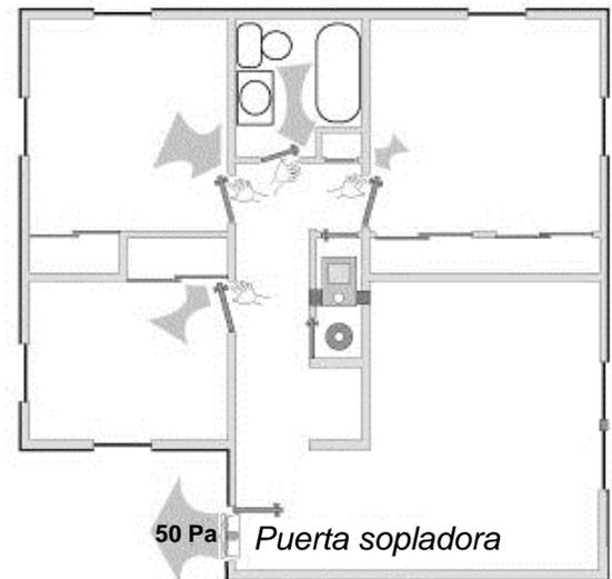
**Prueba de puertas interiores:** el sentir el flujo de aire con la mano en la rendija de una puerta interior brinda una indicación aproximada de la fuga de aire que proviene del exterior a través de esa habitación.
