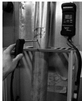
**Comprobación de unidades de calefacción central de más de 80 años:** perforo un agujero de un cuarto de pulgada en el conector metálico del escape para tomar muestras de los gases de combustión.
