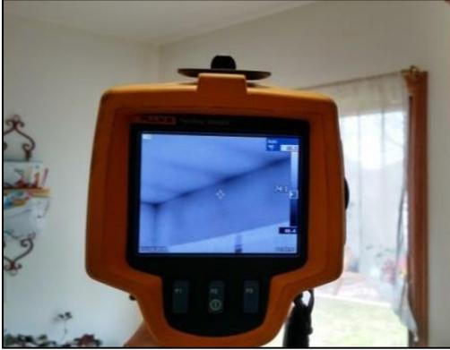
**Escáner de infrarrojos:** permite que el usuario vea las diferencias de temperatura, las cuales verifican la cobertura del aislante en una cavidad de la pared.
