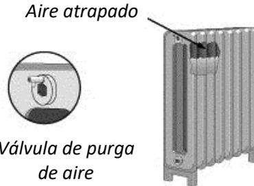
**Purga de aire:** el aire atrapado se acumula en las partes más altas del sistema de agua caliente. La purga del aire de los radiadores llena el radiador y le brinda más superficie de calentamiento.
