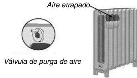
**Purga de aire:** el aire atrapado se acumula en las partes más altas del sistema de agua caliente. La purga del aire de los radiadores llena el radiador y le brinda más superficie de calentamiento.
