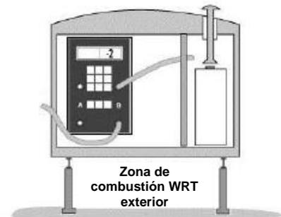
**Prueba del peor caso del calentador de agua:** mida la despresurización en el gabinete del calentador de agua desde el interior si es posible.
