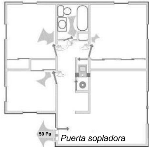
**Prueba de puertas interiores:** el sentir el flujo de aire con la mano en la rendija de una puerta interior brinda una indicación aproximada de la fuga de aire que proviene del exterior a través de esa habitación.
