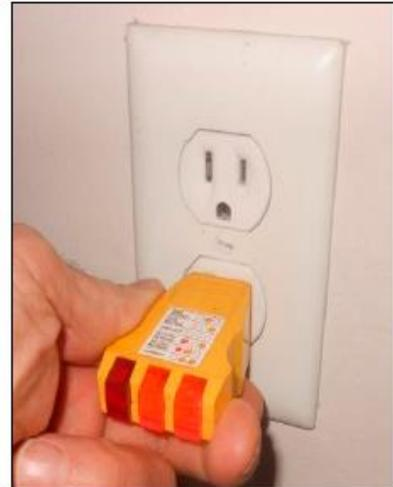
**Comprobación de las paredes:** mida la cavidad y el nivel de aislamiento existente. Asegúrese de que los enchufes de la pared funcionen antes y después de la instalación del aislante.
